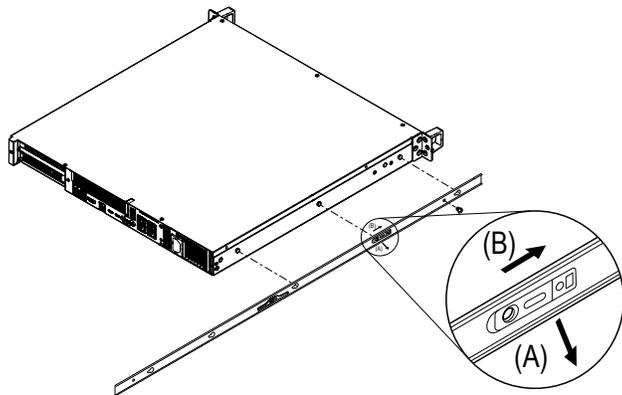
3. 서버 또는 AV 시스템의 쉐시에 분리된 내부 레일을 단단히 밀착시킵니다. 그런 다음 클립(A)을 위로 밀고 내부 레일을 쉐시 후면(B) 쪽으로 밀습니다.
